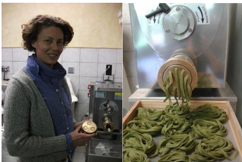
A gauche : Magali nous présente une filière bronze. A droite : les pâtes ressortent de l'extrudeuse, par la filière.
